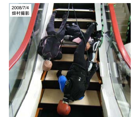
図8 下りエスカレータでの将棋倒し実験
