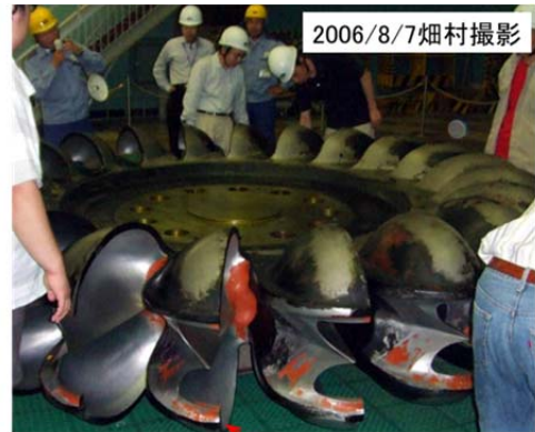
赤い部分は磨耗せず塗料が残っている 写真11 ペルトン水車の実物
