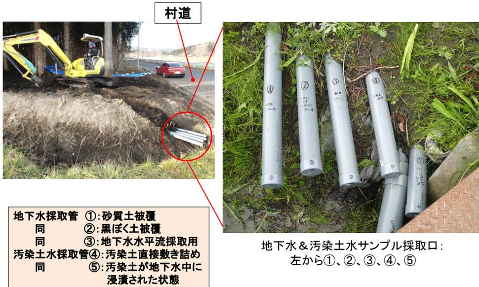
写真4 地下水&汚染土水サンプル採取口
